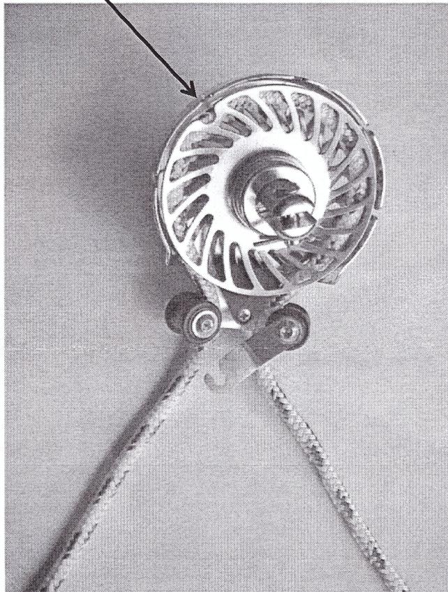
Den Rollenbügel durch Drücken des Bolzens unter der linken Rolle lösen.
