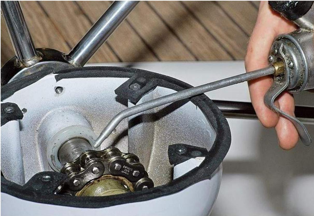
*Steuersystem fetten: In der Säule kann sich das Fett verflüssigen und nach unten laufen. Ketten oder Teller- und Kegelrad nachfetten*
