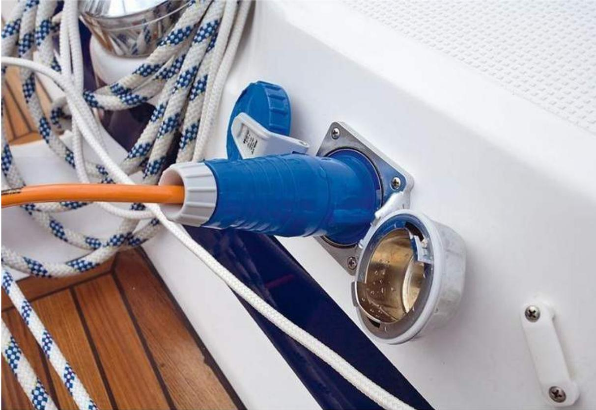
*Landanschluss prüfen: Ist die Kabelisolierung beschädigt oder brüchig, das Kabel ersetzen. Vorsicht bei Zweitdosen und Schukosteckern!*
