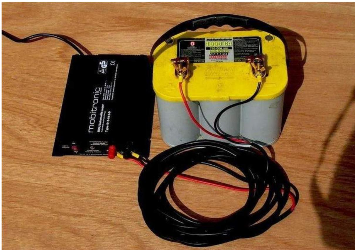
*Batterien laden: Spätestens jetzt im Frühjahr vollladen. Schaltet das Ladegerät nicht auf Erhaltungsladung, können die Batterien defekt sein*
