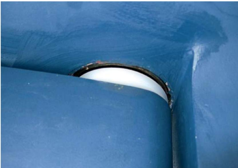
*Ruderlager reinigen: Um an die Lager zu gelangen, muss das Ruder gezogen werden. Danach Muschelkalk entfernen, die Lager nicht fetten*
