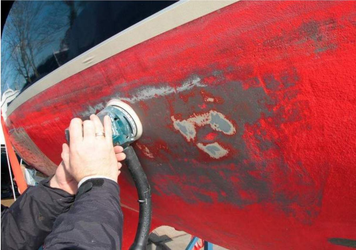
Wer die Reinigung im Herbst versäumt hat, muss im Frühjahr umso mehr Vorarbeit leisten. Normalerweise benötigt selbstpolierendes Antifouling keinen Anschliff vor dem Neuauftrag einer frischen Schicht. Wurde aber der Algenbewuchs im Herbst nicht entfernt, liegt er jetzt als getrocknete Schicht auf dem Antifouling. Da hilft meist nur Anschleifen, um spätere Ablösungen zu vermeiden.
