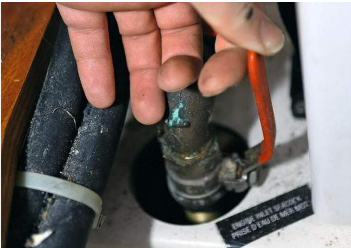
*Seeventile bedienen: Alle Ventile mehrmals öffnen und schließen, um sie gängig zu halten. Bleiben sie schwer bedienbar, sollten sie ersetzt werden*
