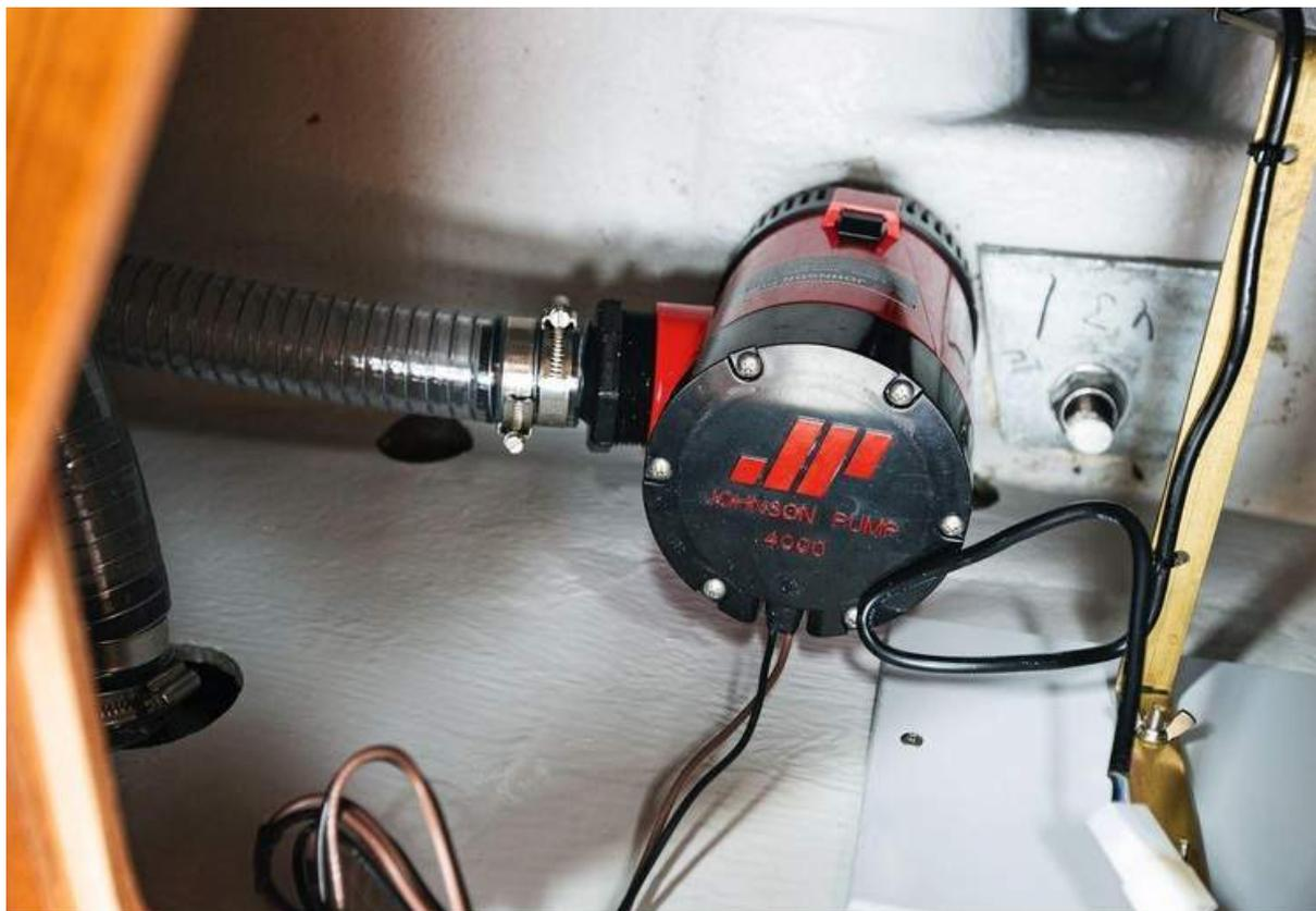
*Kabelanschlüsse ansehen: In der Bilge und am Kühlschrank können Kabelverbindungen korrodieren. Diese Bereiche gründlich in Augenschein nehmen*
