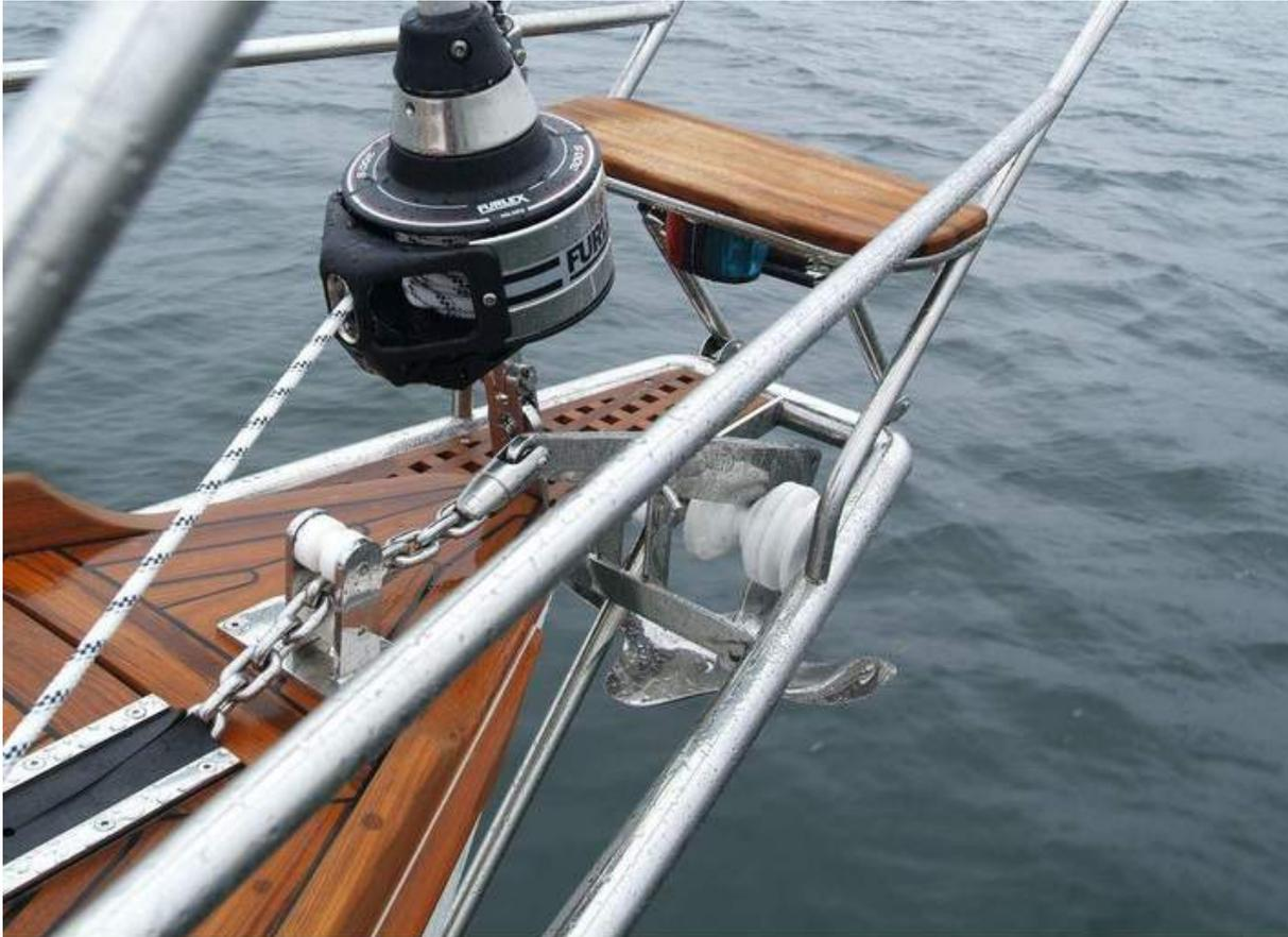
*Rollanlage: Auf Leichtgängigkeit und Beschädigungen prüfen, auch den Draht oben, er kann sich bei Fehlbedienung aufdrehen*
